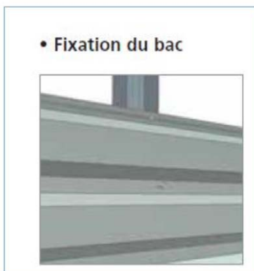
Schéma 3 : fixation des bacs Megastil® sur les montants Megastil®
